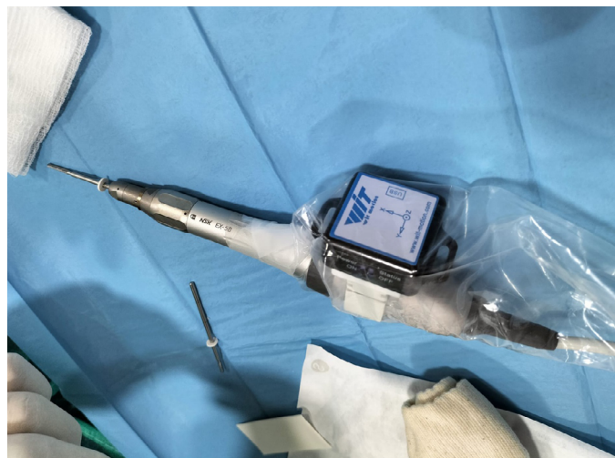
Figura 2. Inclímetro incorporado al motor quirúrgico.
