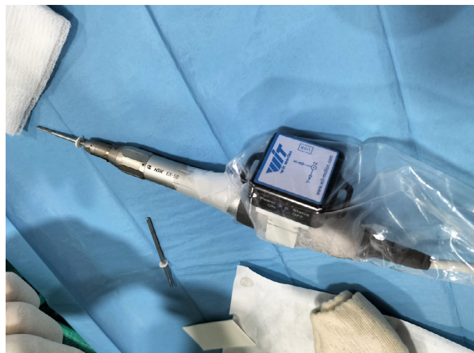
Figura 2. Inclímetro incorporado al motor quirúrgico.
