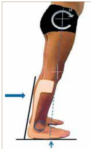
Figura 7. La AFO sólida direcciona las FRS para reducir el recurvatum de la rodilla.
