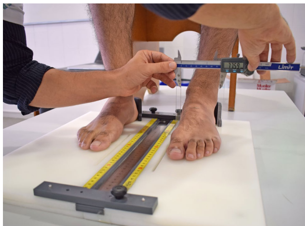
Figura 4. Medición de la anchura del mediopié mediante el calibre modificado.
